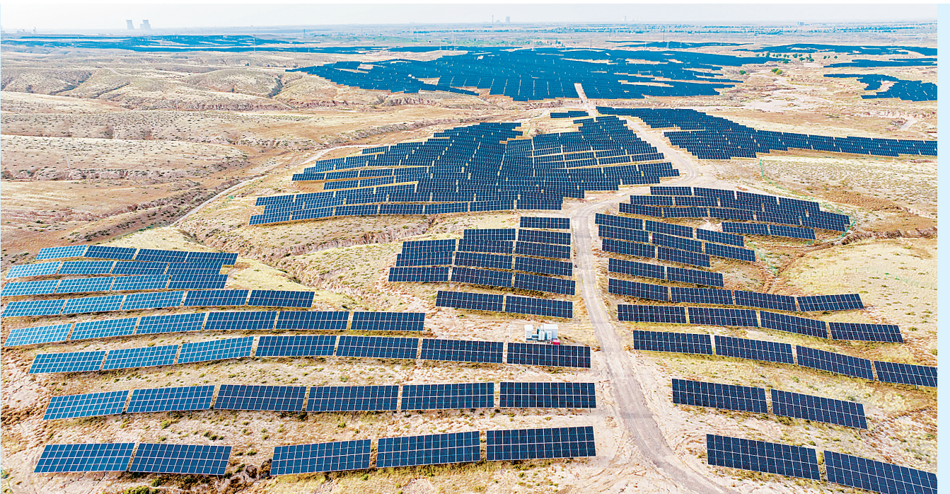
这是5月20日拍摄的位于宁夏宁东基地的绿氢一体化第一光伏电站(无人机照片)。 近年来,宁夏依托当地光照和土地优势,大力发展集中式风光基地,构建新型能源体系,助力能源强国建设。2026年第一季度宁夏光伏发电新增并网容量215.7万千瓦,其中集中式光伏电站新增并网容量213.3万千瓦。 (新华社记者 杨植森 摄)
